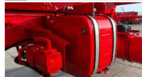
I120 Kipsysteem via motor-pomp op LS
